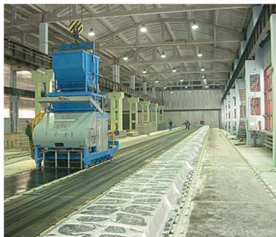
Цех с линией безопалубочного формования
