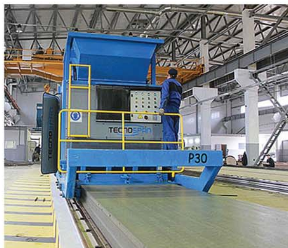
Формовка плиты перекрытия
